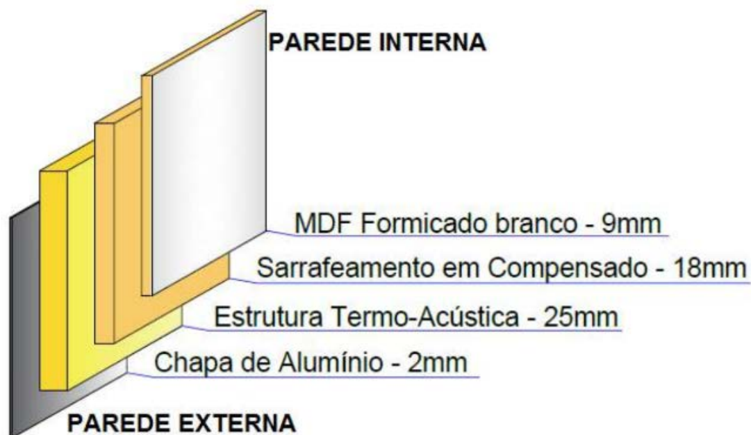
Figura 01 – Camadas e espessuras dos revestimentos.
